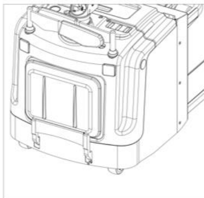
Рис. 12 – Использование платформы и защитных поручней
