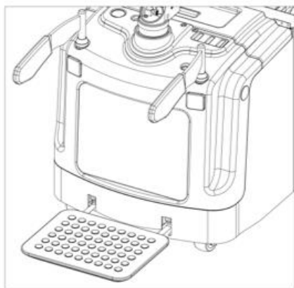
Рис. 12 – Использование платформы и защитных поручней
